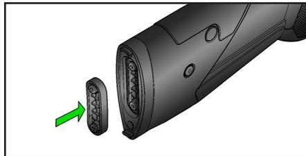
6. Rimontare il **calciolo "1"** e fissarlo con le due viti presenti nel KIT, avendo cura di utilizzare le viti di **lunghezza media** in caso di utilizzo di una sola coppia di spessori, o **le più lunghe** per due coppie di spessori (cacciavite a croce, coppia di serraggio consigliata **2 Nm**).
