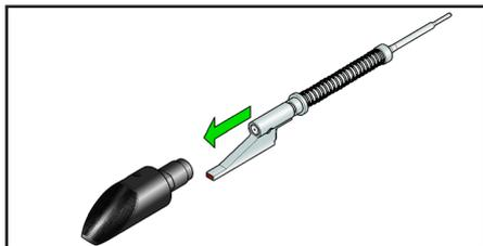
6. Inserire il **tappo otturatore** nel gruppo otturatore allineando i segni presenti sui due componenti; comprimere la molla **(a)** premendo contemporaneamente il pulsante laterale **(b)**, quindi ruotare il tappo otturatore **in senso antiorario (c)**.
