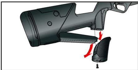
3. Rimontare il **grip dell'impugnatura** con l'apposita vite di fissaggio.
