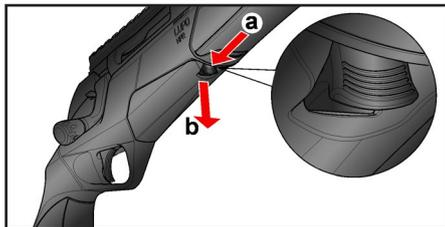
2. Aprire l'**otturatore (a-b)**: la cartuccia in camera viene così estratta ed espulsa.
