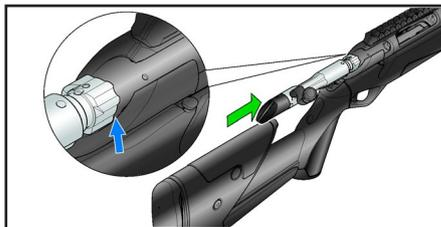
3. Avanzare l'**otturatore** e ruotarlo tramite la **manetta** fino a portarlo in chiusura.
