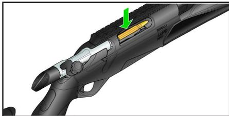
La successiva chiusura manuale dell'otturatore porterà la prima cartuccia del caricatore in camera, rendendo l'arma pronta a sparare.
