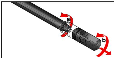
Per il rimontaggio, avvitare il freno di bocca **(b)** con la relativa ghiera di fissaggio **(a)** sulla volata canna, **ORIENTARLO CORRETTAMENTE**, quindi serrare la ghiera di fissaggio **(a)**.
