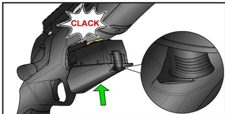
A questo punto **l'arma è completamente carica**: portando la sicura in posizione di sparo (**punto rosso visibile**), l'arma è pronta a sparare.
