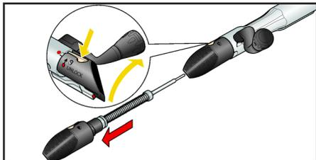
**NOTA:** In caso di rotazione in senso errato (antiorario), inserire il gruppo otturatore rovesciato nelle guide sul fodero e ruotarlo, riportando il tappo nella posizione iniziale.
