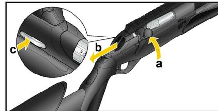
**NOTA:** Per evitare eventuali interferenze con il nasello regolabile, ruotare l'otturatore di 180° (rispetto alla posizione di chiusura) per poterlo sfilare dal fodero senza necessità di modificare la posizione del nasello.
