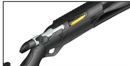
6. Avanzare l'**otturatore (a)** per incamerare la prima cartuccia presente nel caricatore, quindi portare l'otturatore in chiusura (**b**).
