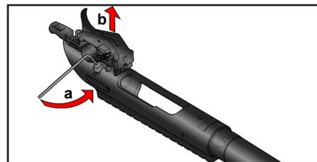
**NOTA:** Verificare che il perno fissaggio del bottone fermo otturatore, una volta separato il gruppo guardia, rimanga in posizione.
