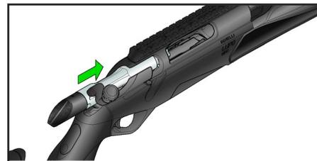
**NOTA:** Per evitare eventuali interferenze con il nasello regolabile, ruotare l'otturatore di 180° (rispetto alla posizione di chiusura) per poterlo sfilare dal fodero senza necessità di modificare la posizione del nasello.
