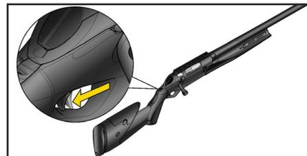
4. Sparato il primo colpo, rilasciare completamente il grilletto, aprire l'otturatore (**a**) ed arretrarlo (**b**).
