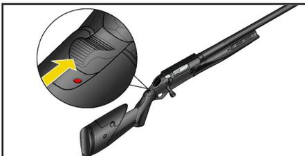
2. Verificare che il **grilletto** sia armato, per la presenza del punto rosso visibile sul dente di agganciamento in coda al fodero.
