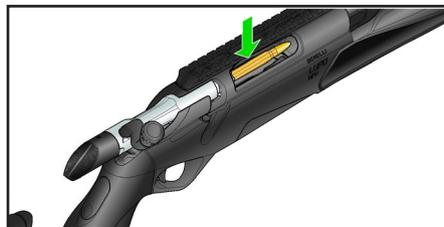
3. Avanzare (a) e ruotare (b) l'otturatore dell'arma portandolo in chiusura.
