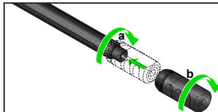
**Attenzione:** Si raccomanda di utilizzare **SOLO** freni di bocca (o altri accessori) il cui **DIAMETRO INTERNO** sia compatibile con il **CALIBRO DELL'ARMA**.
